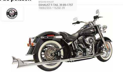
Ligne d'échappement True Dual avec silencieux en queue de poisson
